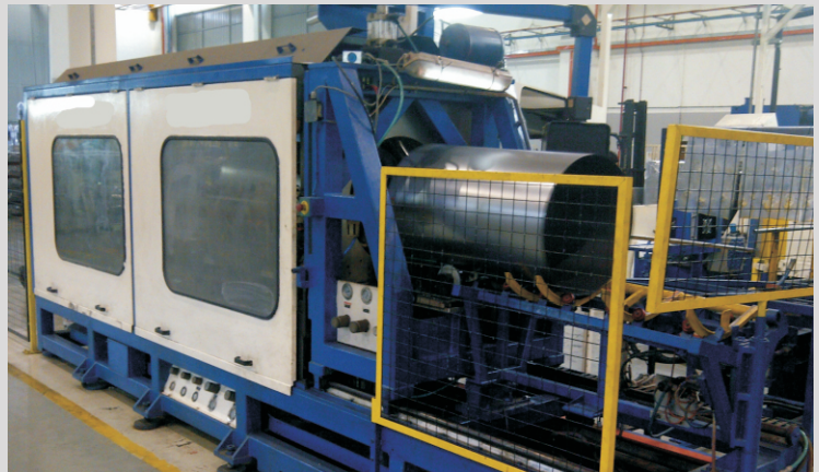
Rollnahtschweißanlage für Ölfässer in Singapur
